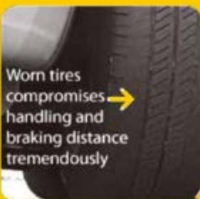
هر تایر یک تشانگر سایش آج<sup>△</sup> یا همان TWI دارد که به شکل  $\triangle$  یا حروف TWI در بالای دیواره حک شده است. TWI یک تشانگر سایش آج و همچنین یک شاخص برای مصرف کننده است تا در صورت صاف و غیر این بودن آج تایر، آن را تعویض کند. اگر آج تایر به سطح TWI برسد باید بللافاصله تایر را جایگزین کرد.
