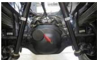
پیچ سرریز روغن واسکازین دیفرانسیل محور عقب
