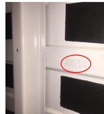
شماره بدنه حک شده روی ستون مرکزی صفحه پشتی داخل کابین
