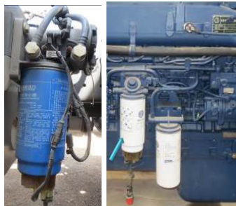
فیلتر آب گیر اولیه سوخت کنار تانک ادبلو فیلتر آب گیر ثانویه سوخت روی موتور
