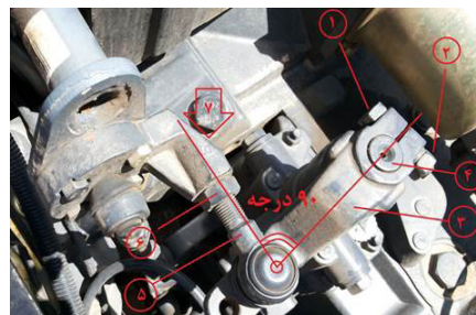
نمای بالای مکانیزم تعویض دنده (تصویر (۲))
