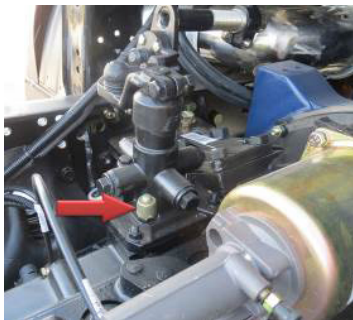
سوپاپ تنفسی روی گیربکس
