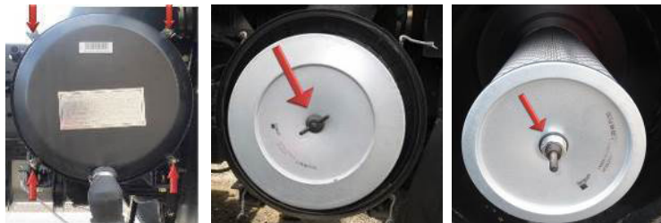
مهره های خروسکدر بمحفظه فیلتر هوا مهره قفلی فیلتر بیرونی مهره قفلی فیلتر داخلی
