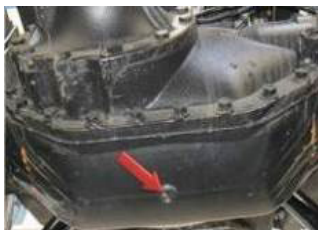
پیچ تخلیه دیفرانسیل محور عقب
