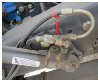
فیتینگ شیلنگ ورودی روی جک بالابر
