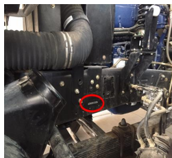
شماره شاسی حک شده روی تیر سمت راست شاسی قسمت عقب چرخ جلو
