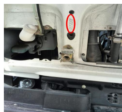
شماره بدنه حک شده روی ستون سمت شاگرد زیر جلو پنجره
