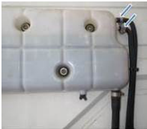
شیلنگ های هواگیری متصل به موتور و رادیاتور
