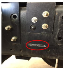
شماره شاسی حک شده روی تیر سمت چپ شاسی قسمت جلوی چرخ عقب
