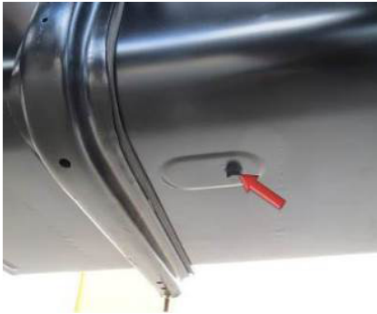
پیچ تخلیه باک سوخت
