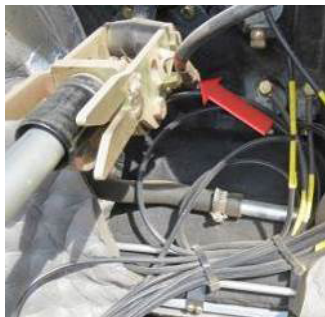
فیتینگ انتهایی شیلنگ متصل به گیره تلسکوپی
